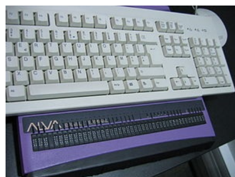
Počítačová klávesnice, pod ní je výstupní zařízení zobrazující text v Braillově písmu
