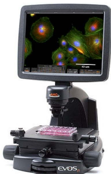
Fluorescenční mikroskop AMG Evos fl s LCD displejem místo okuláru
